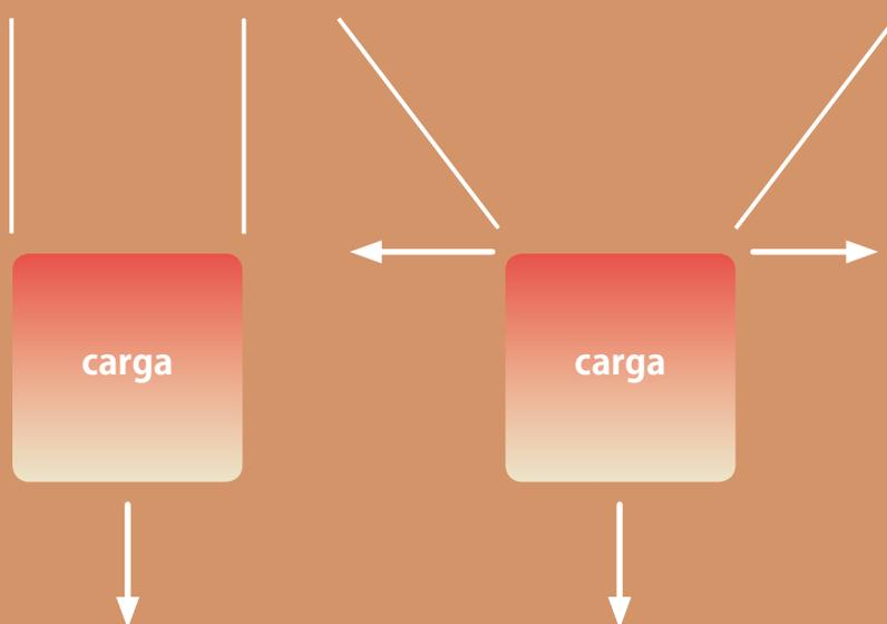
La combinación de estas fuerzas incrementa la tensión sobre el cable. En la medida que el ángulo del cable sobre la vertical es más grande, la componente lateral es mayor.
